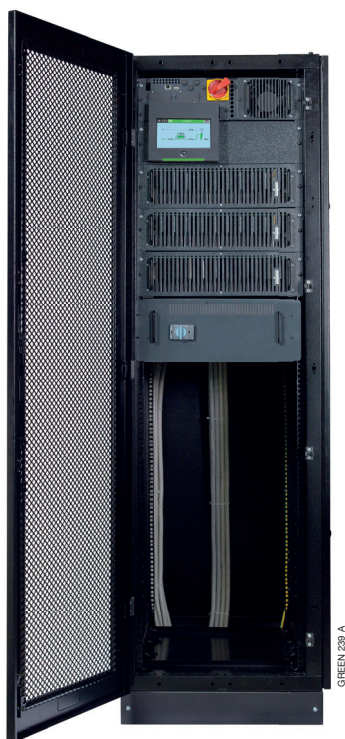
Esempio di integrazione (3x25 kW). Solo 15U di rack occupate: il design compatto lascia spazio per altri dispositivi montati a rack. Uno slot vuoto nel subrack MODULYS RM GP resta disponibile per aumento della potenza o per ridondanza.
